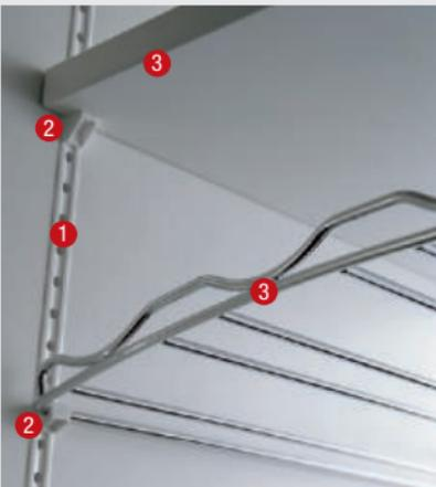
**Das MultiMatic System und was dazugehört:** 1 Die Multifunktions-schiene, unterteilt im feinen 16 mm-Raster. 2 Die SieMatic Ausstattungsträger, die einfach und sicher durch eine 90°-Drehung in der Schiene fixiert werden. 3 Die vielen SieMatic Ausstattungselemente: hochwertig verchromt, dadurch langlebig und durch Geschmacks- bzw. Gebrauchsmusterschutz vor Nachahmung geschützt.
